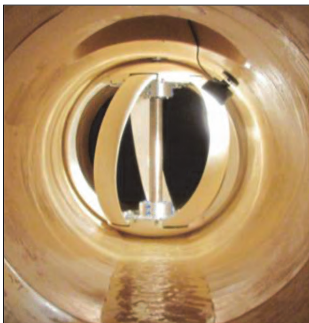
Figure 2-31: Spherical turbine (Kanagy, 2011)
