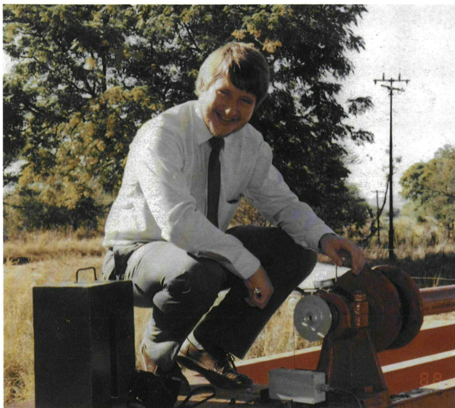
Mnr Nico Benade van die Laboratorium vir Stelsels (RAU) by die dataregistreerder by die sluis in die linkerbank hoofkanaal by Loskop Staatswaterskema. Die dataregistreerder monitor die sluisopening asook die waterdiepte voor die sluis.
