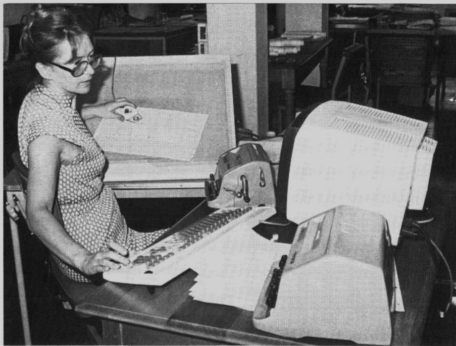
Die oue en die nuwe. Die operatrise is besig om stroomvloeddata met 'n moderne D-MAC aftasser te versyfer. Op die tafel staan die ou handmasjien (met die slinger), die aftasser se skerm en die elektriese apparaat waarmee die data vroeëre verwerk is.
