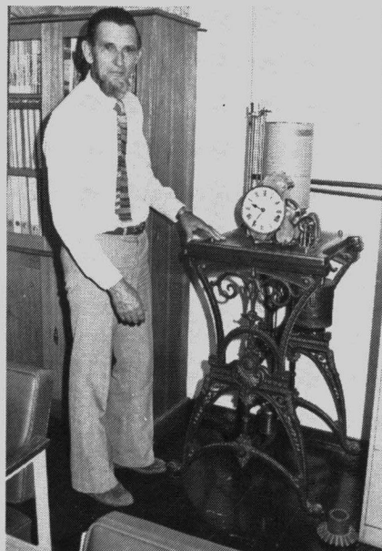
Mnr Al Rabie, direkteur Hidrologie, by een van die eerste watervlak-registreerders wat in Suid-Afrika gebruik is. Dit dateer uit die jare 1900-1901.
