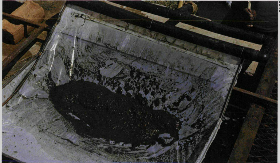
Die oes van die alge. Tydens die oesproses word die alge met 'n nylonnet uit die water gesif. Die openinge in dié net is 63 \mu\text{m} groot, maar openinge van tot 112 \mu\text{m} is ook voldoende.
