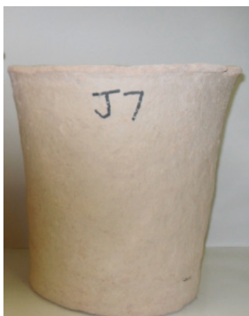
Porous clay pot control (J7)
