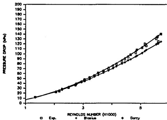
**FIGURE 3.15 : COMPARISON OF EXPERIMENTAL AND SIMULATED PRESSURE DROP - MODULE N150L300**
