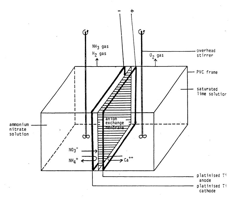
anode reaction :  $2H_2O - 4e \longrightarrow O_2 + 4H^+$  cathode reaction :  $4H_2O + 4e \longrightarrow 4OH^- + 2H_2$
