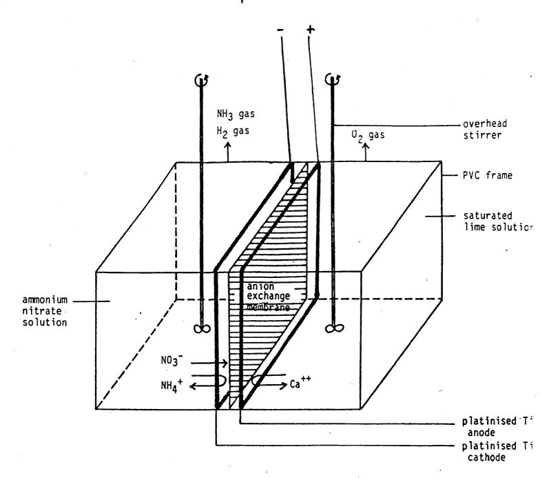
anode reaction :  $2H_2O - 4e \longrightarrow O_2 + 4H^+$ cathode reaction :  $4H_2O + 4e \longrightarrow 4OH^- + 2H_2$
