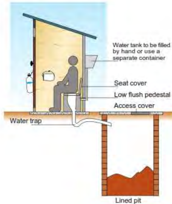
Figure 45 Pour flush/low flush toilet system arrangement, DWAF 2002
